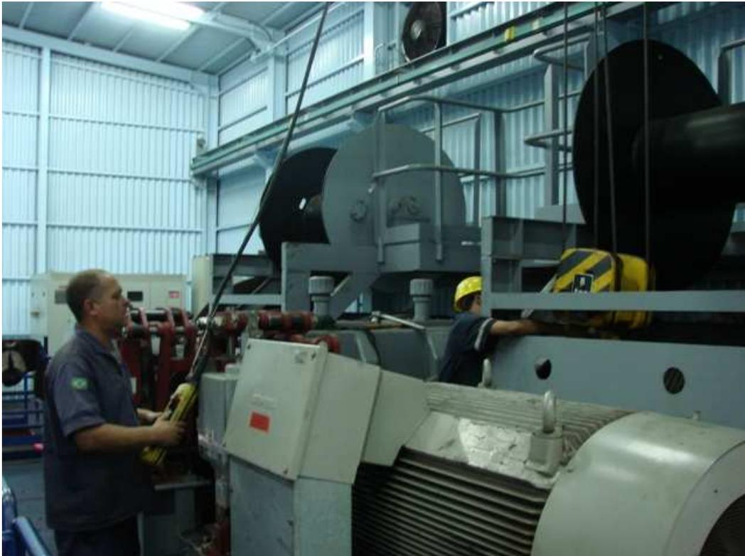
PT-02 - Montagem do grupo de comando de emergência no sistema de elevação
