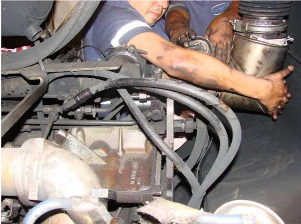
Montagem do coletor de descarga do motor MAN do GR04
