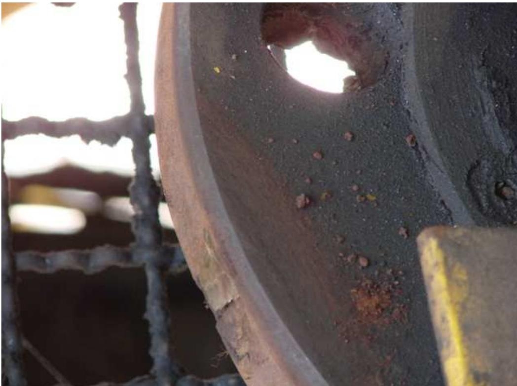
PT01 – Roda guia apresentando trinca. Foi substituída.
