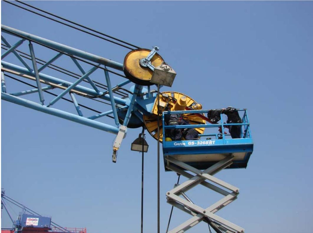
GR-02 – Reparo nas embreagens de um dos motores de enrolador do cabo elétrico
