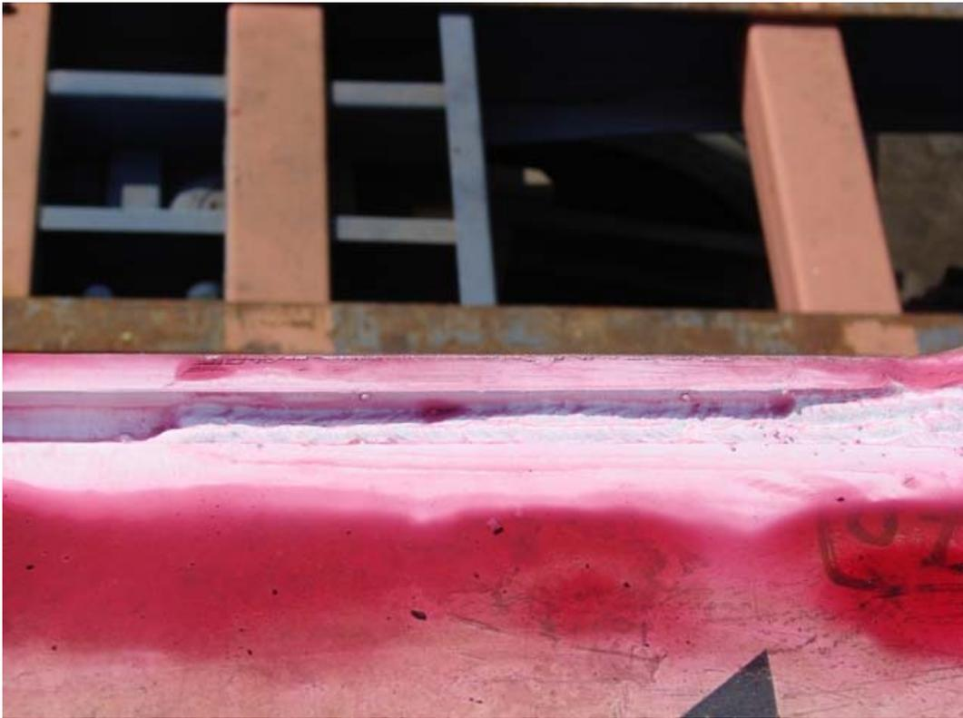
EC-21 Ensaio de líquidos penetrantes na solda da trinca da lança
