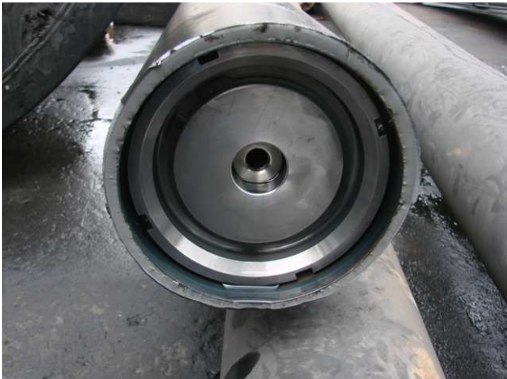
EC-23 – Verificação das causas do acidente que rompeu o fechamento do cilindro de extensão da lança
