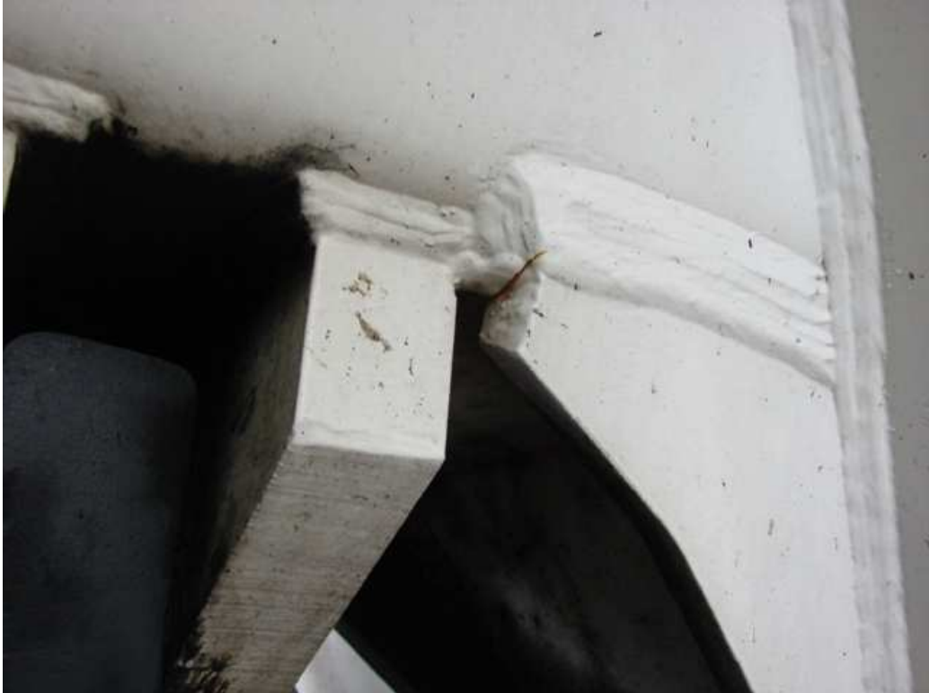
EC-21 – Na inspeção identificadas trincas no spreader e na lança
